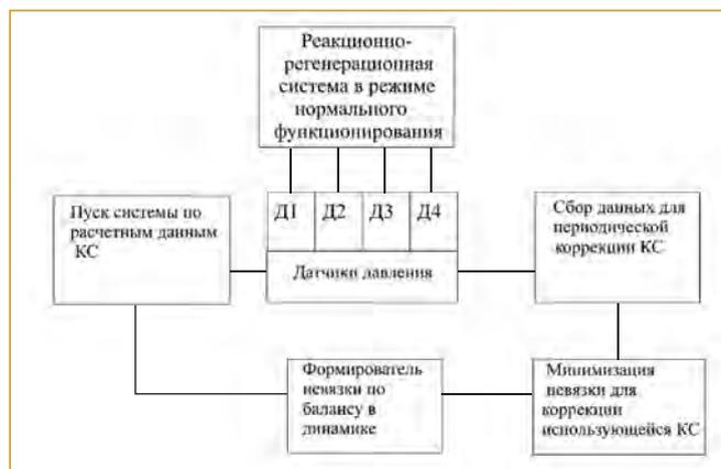
Рис. 2. Функциональная структура системы косвенного измерения скорости пневмотранспорта с самонастраиванием
