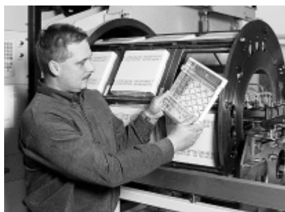
Рис. 4. Установка для вакуумного напыления сверхтонкого алюминиевого покрытия в цехе фирмы OKW (Бухен, Германия)
