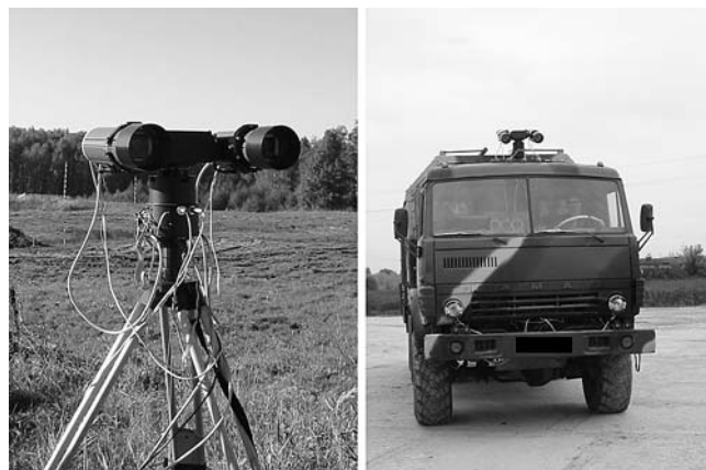
Рис. 2. Телевизионная стереосистема на устройстве позиционирования и смонтированная на автомобиле КАМАЗ
