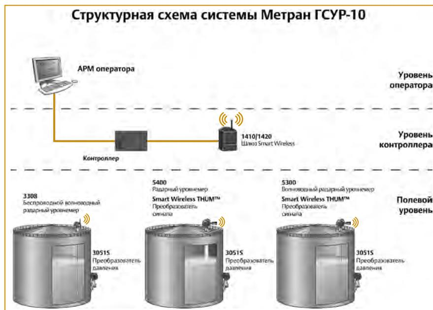
Рис. 2. Структурная схема системы Метран ГСУР-10
