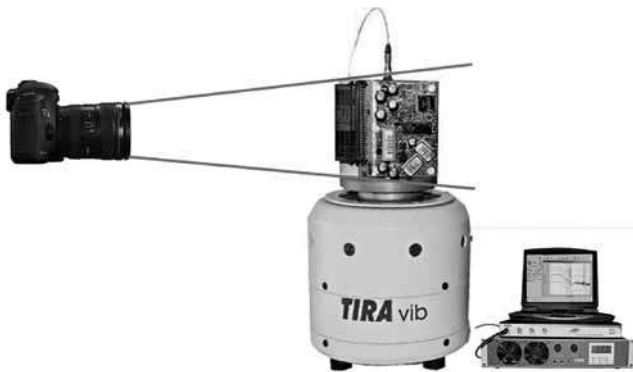
Рис. 1. Оптический метод измерения амплитуды вибрации испытуемого объекта
