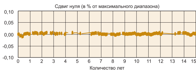
Рис. 3. Результаты проверки долговременного дрейфа
