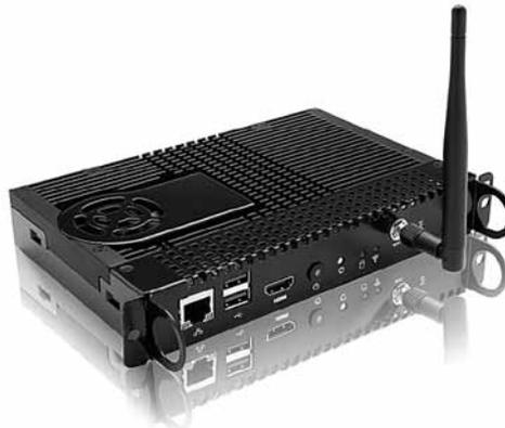
Рис. 2. Встраиваемое решение компании Kontron для цифровых систем оповещения и рекламы, выполненное на основе модуля COM Express
