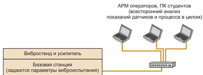
Рис. 1. Функциональная схема распределенной системы автоматического управления и контроля в лаборатории вуза
