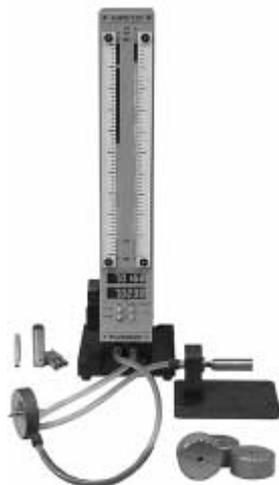
Рис. 5. Пневмоэлектронный длиномер "Аэротест 2/10-200 ДЦ" с измерительной оснасткой для контроля форсунок двигателя Д-100
