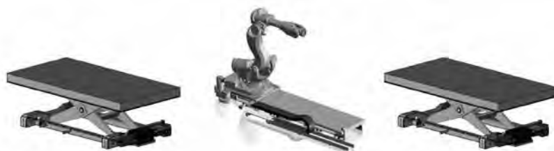
Рис. 4. Общий вид зоны загрузки штамповочных заготовок
