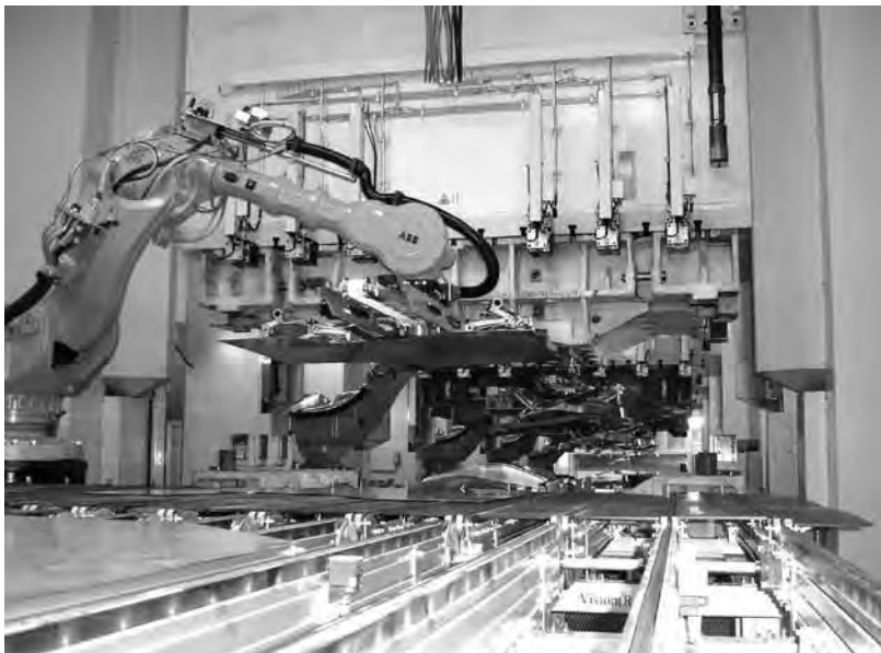
Рис. 5. Общий вид участка укладки заготовки из загрузочного конвейера в первый пресс
