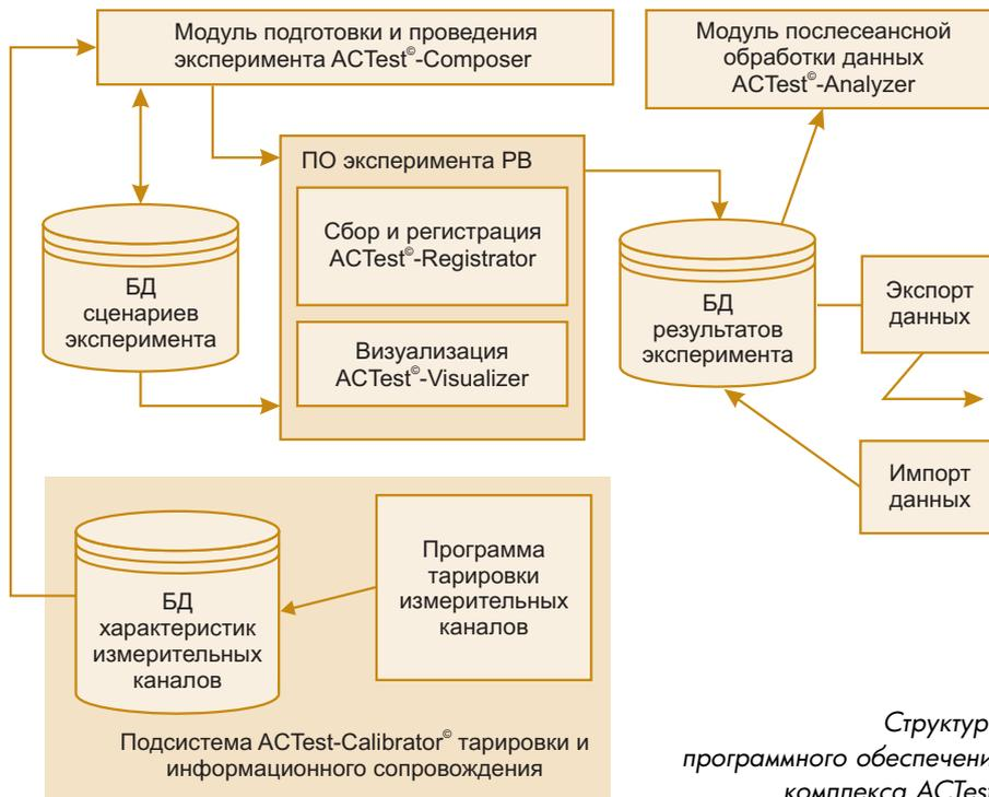
Структура программного обеспечения комплекса ACtest®
