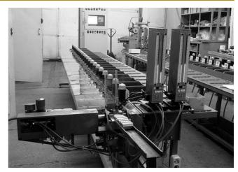
струмент" спроектировало и изготавливает полуавтоматический прибор подборки роликов при сборке подшипников железнодорожных вагонов. Опыт ижевского предприятия по созданию автоматических и полуавтоматических средств измерения для подшипниковой промышленности может быть распространен на изделия с другими размерами и формой.
