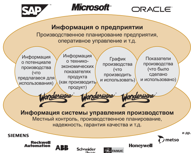
Рис. 1. Приложение Wonderware Enterprise Integration обеспечивает интеграцию систем планирования ресурсов (ERP) и систем управления производством (MES)
