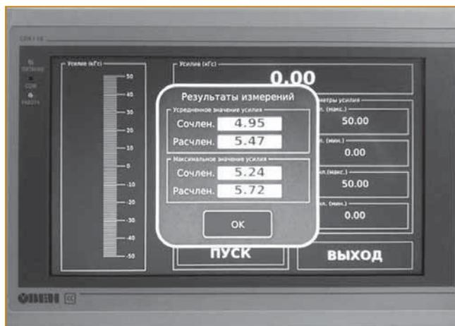
Рис. 4. Визуализация окна с результатами измерения
