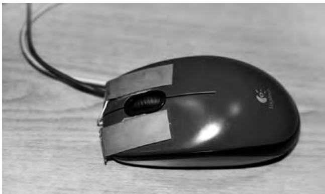
Рис. 3. Макет модифицированного манипулятора «мышь» для съема КГР
