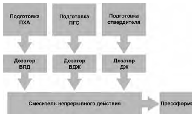
Рис. 1. Упрощенная структурная схема ТП приготовления ВЭМ
