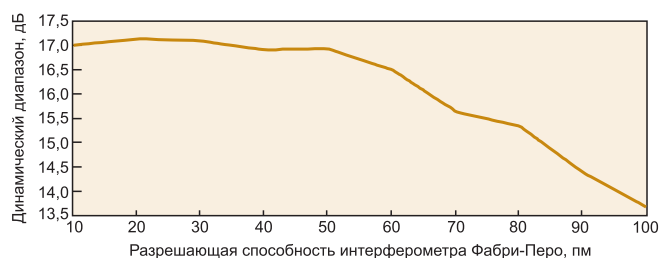
Рис. 7. Влияние разрешающей способности интерферометра Фабри-Перо на динамический диапазон, при котором погрешность измерения резонансной длины волны \leq 10 пм
