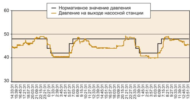
Рис. 7, б. Сравнение графика давления на насосной станции и графика нормативного давления
