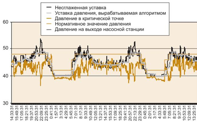
Рис. 7, а. Подробные графики давления на насосной станции
