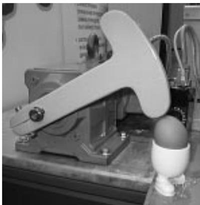
*Рис. 3. Яйцу ничего не грозит. Мотор-редуктор под управлением преобразователя частоты Danfoss и системы промышленного зрения LightPix (Panasonic) остановит молоток в миллиметре от скорлупы. Точность позиционирования вала редуктора – десятые доли градуса (стенд ООО "ЭФО")*
