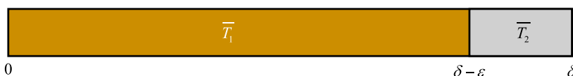
Рис. 2. Схематичный рисунок сляба, разбитого на участки 0 \leq y \leq \delta - \varepsilon (толстый слой) и \delta - \varepsilon \leq y \leq \delta (тонкий слой)
