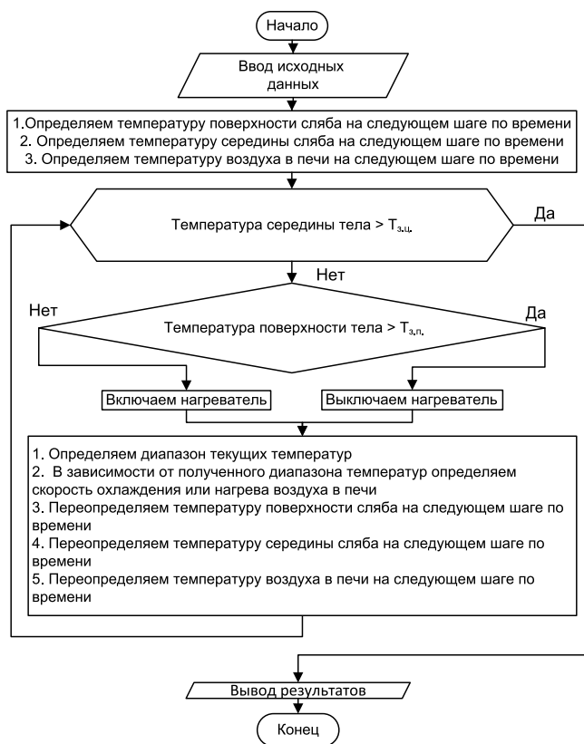
Рис. 5. Алгоритм управления нагревом материалов в печи
