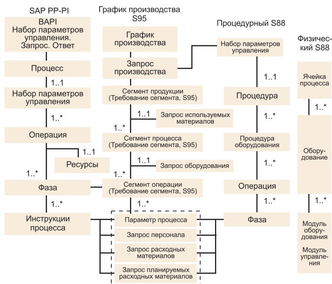
Рис. 4. Примерная система преобразования данных из SAP PP-PI в S88
