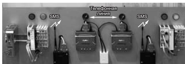
Рис. 2. Удаленный сбор данных по выделенному каналу с резервированием по GSM каналу (SMS)
