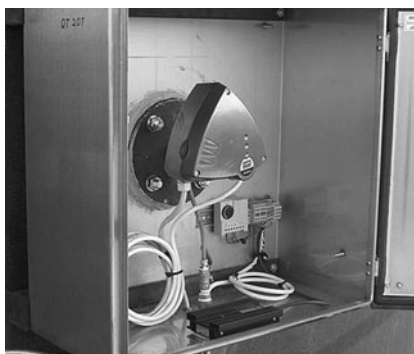
Рис. 7. Измерение концентрации пыли прибором ProSens
