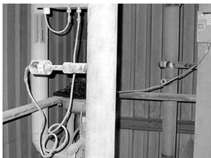
Рис. 2. Дозирование известковой муки на базе расходомера Solid Flow
