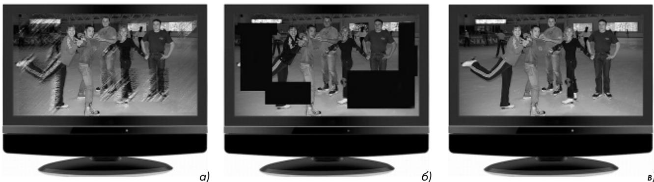
Рис. 4. Сравнение искажений сжатого/несжатого видео при возникновении потерь Ethernet пакетов: потеря пакетов при передаче видео со сжатием – появляются размытые области (а), без сжатия – появляются цветные "квадратики" (б), технология PerfectPixel позволяет передавать видео без искажений даже при наличии потерь пакетов (в)
