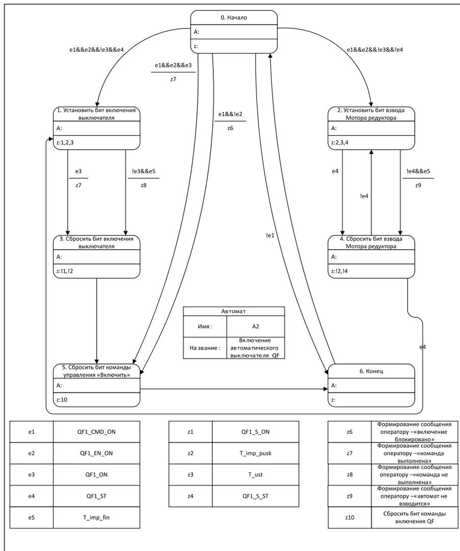
Рис. 4. Автоматная модель алгоритма включения автоматического выключателя QF
