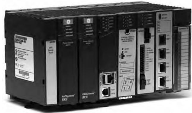
Рис. 1. Модульная, масштабируемая и высокопроизводительная платформа RX3i
