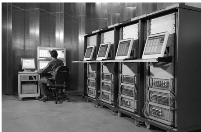
Рис. 1. Система виброиспытаний фирмы LMS на внешние воздействия (>500 каналов) в Европейском космическом агентстве
