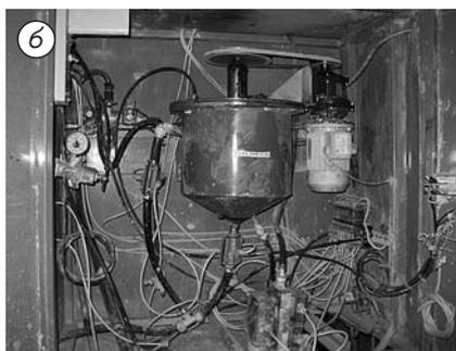
Рис. 3. Технологические средства системы отбора представительных проб и отправки их на анализ: ШТО1 (а) приемно-распределительное устройство и ШТО2 (б)
