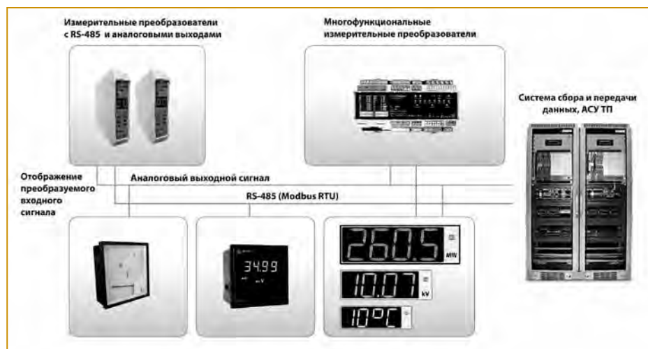
Рис. 1. Схема измерения, отображения и передачи данных в АСУТП с помощью применения электроизмерительных преобразователей и цифрового табло
