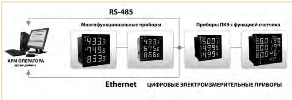
Рис. 2. Схема измерения, отображения и передачи данных с помощью применения цифровых приборов с индикацией
