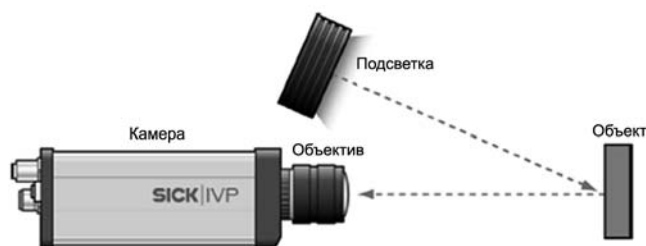
Рис. 2. Общий принцип работы системы технического зрения
