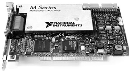
ства устройств сбора данных М серии. Объединение передовых технологий позволяет осуществлять высокоскоростной аналоговый и цифровой ввод/вывод с заранее определенной полосой пропускания на каждый слот шины PCI Express. Устройства имеют до 32-х каналов аналогового ввода с разрешением 16 разрядов и частотой оцифровки 1,25 МГц и до 32-х цифровых линий ввода/вывода с частотой дискретизации 10 МГц.
