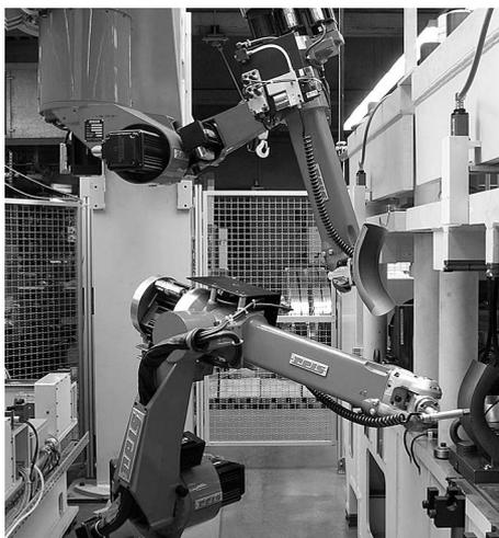
*Робот с вертикальной ломающейся рукой с высокой динамикой и точностью фирмы Reis Robotics (Германия)*
