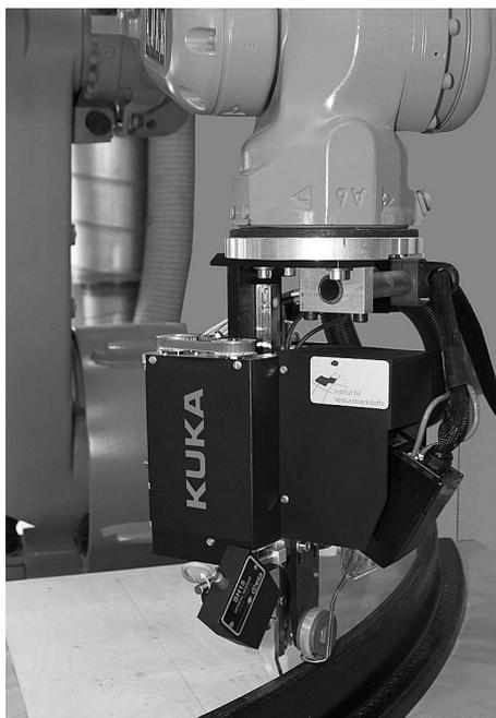
Робототехническая сварочная система Kuka System GmbH
