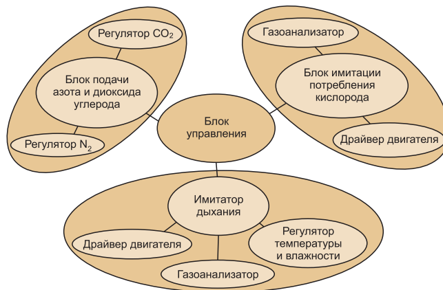
Рис. 5. Схема применения оборудования в испытательном стенде ИЛ
