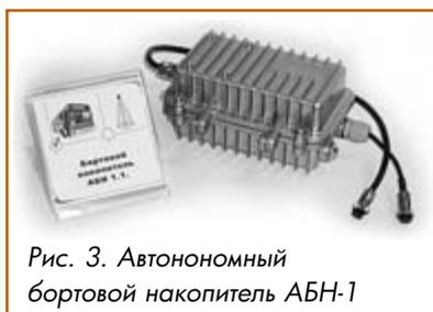
Рис. 3. Автономный бортовой накопитель АБН-1
