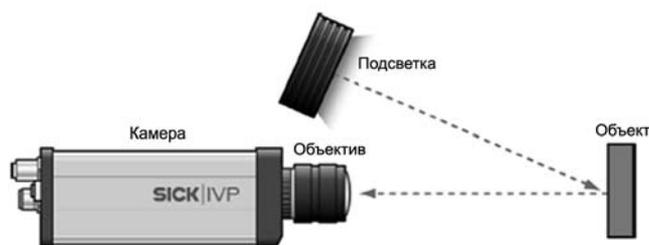
Рис. 2. Общий принцип работы системы технического зрения
