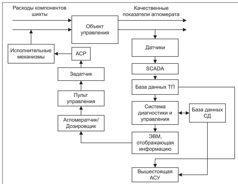
Рис. 2. Структурная схема АСУТП, оснащенная системой диагностики и управления, выполняющей функцию советчика технического персонала
