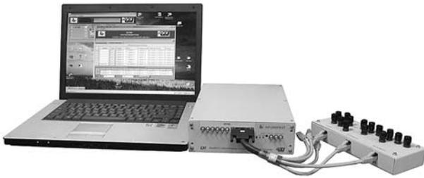
Рис. 3. Портативная динамическая тензостанция ТС-6К
