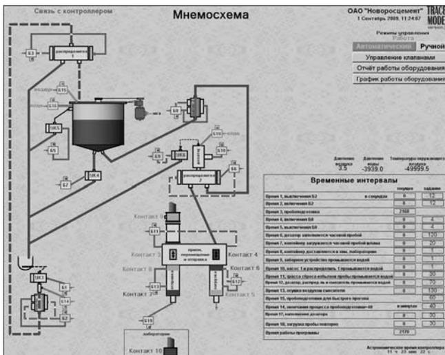
Рис. 6. Мнемосхема пневмопочты
