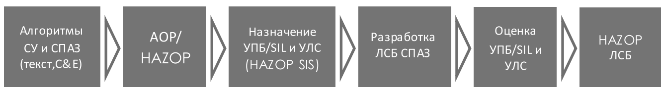
Рис. 3. Рекомендуемая последовательность разработки логических схем блокировки систем ПАЗ
