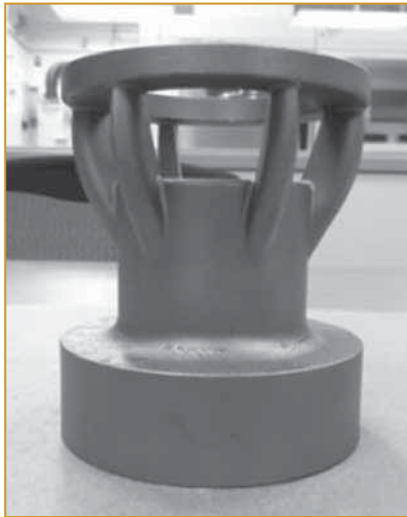
Рис. 3. Образец детали клапана CCV-N
