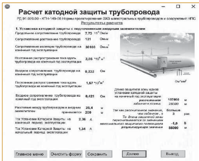
Рис. 3. Расчет катодной защиты проектируемого нефтепровода
