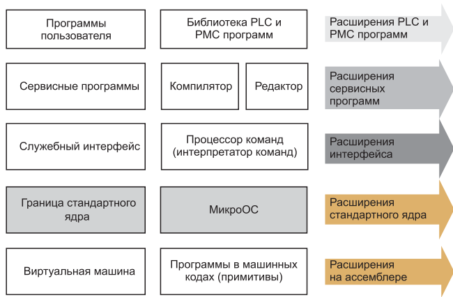
Рис. 1. Структура ПО СУД, основанная на виртуальной машине
