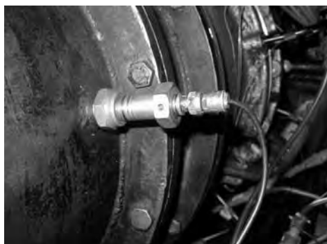
Рис. 3б. Антенна в трубопроводе стенда
