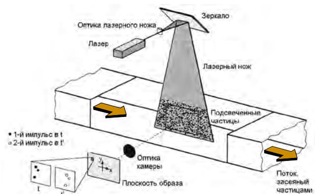
Рис. 1. Экспериментальная установка PIV в аэродинамической трубе
