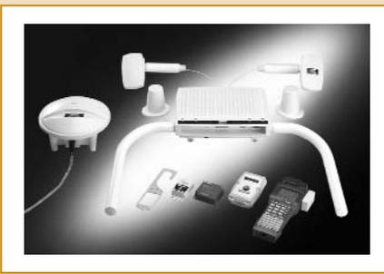
Система идентификации Moby R состоит из триггеров, передатчиков, антенн и серверов, а также прикладного ПО. Передатчик устанавливается непосредственно на объекте и активно излучает свой однозначный идентификационный номер. Последний принимается антеннами, которые через LAN связаны с центральным
